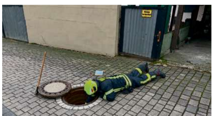
Gasmessung an einem Kanalschacht 1.
